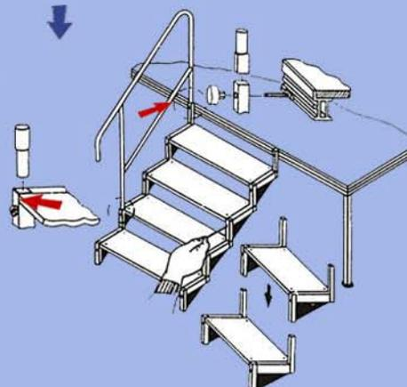
Mittels Gewindeschlitten + Sterngriff werden die Geländer am Podest be-festigt (Befestigung der Treppe mit gleichem Mon-tagematerial, siehe rechts).
