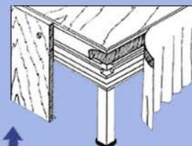
Die Holzverblendung (links) ist mit Einhängeklinten ver-sehen, die einfach in die Montagenut eingehängt werden.
